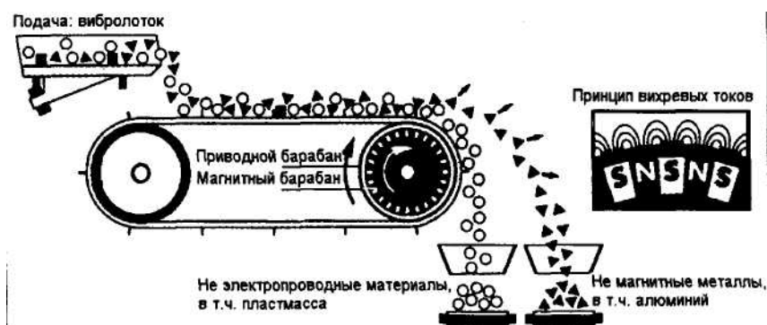
Рис.. 4.8 Принципиальная схема сепаратора немагнитных металлов
