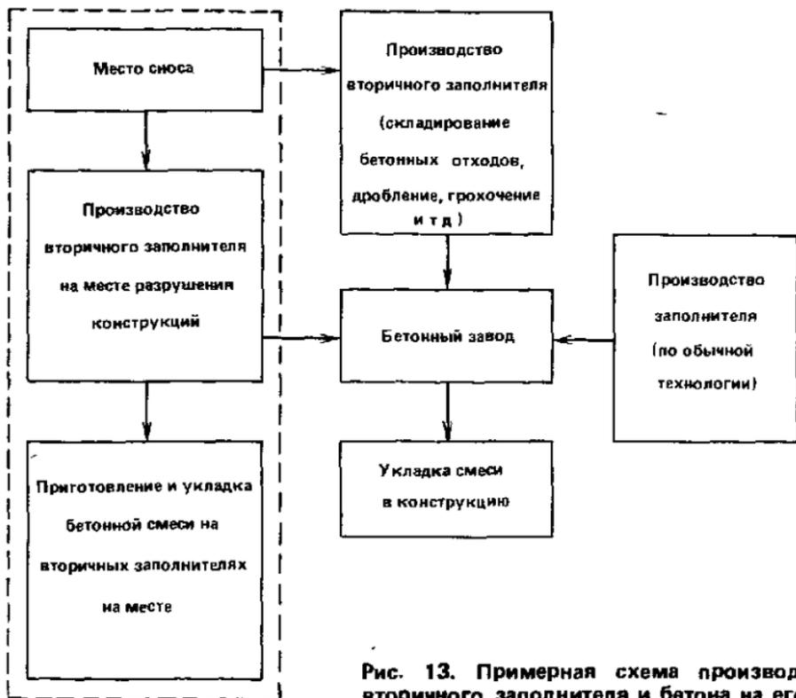
Рис. 13. Примерная схема производства вторичного заполнителя и бетона на его основе в Японии
