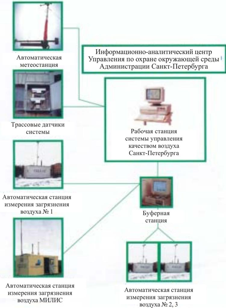
**Рис. 8. Схема передачи данных о состоянии воздушной среды в информационно-аналитический центр**
