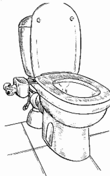
Рис. 4. Унитаз-компакт со специальным устройством для слива воды.
