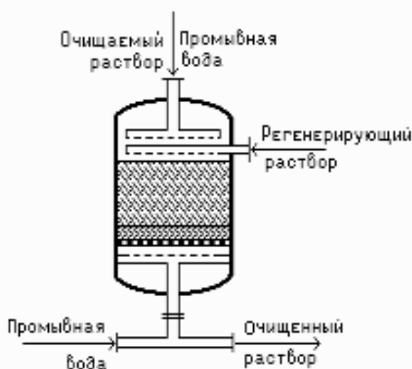
Рис. 10.1. Ионообменный аппарат с неподвижным слоем ионита
