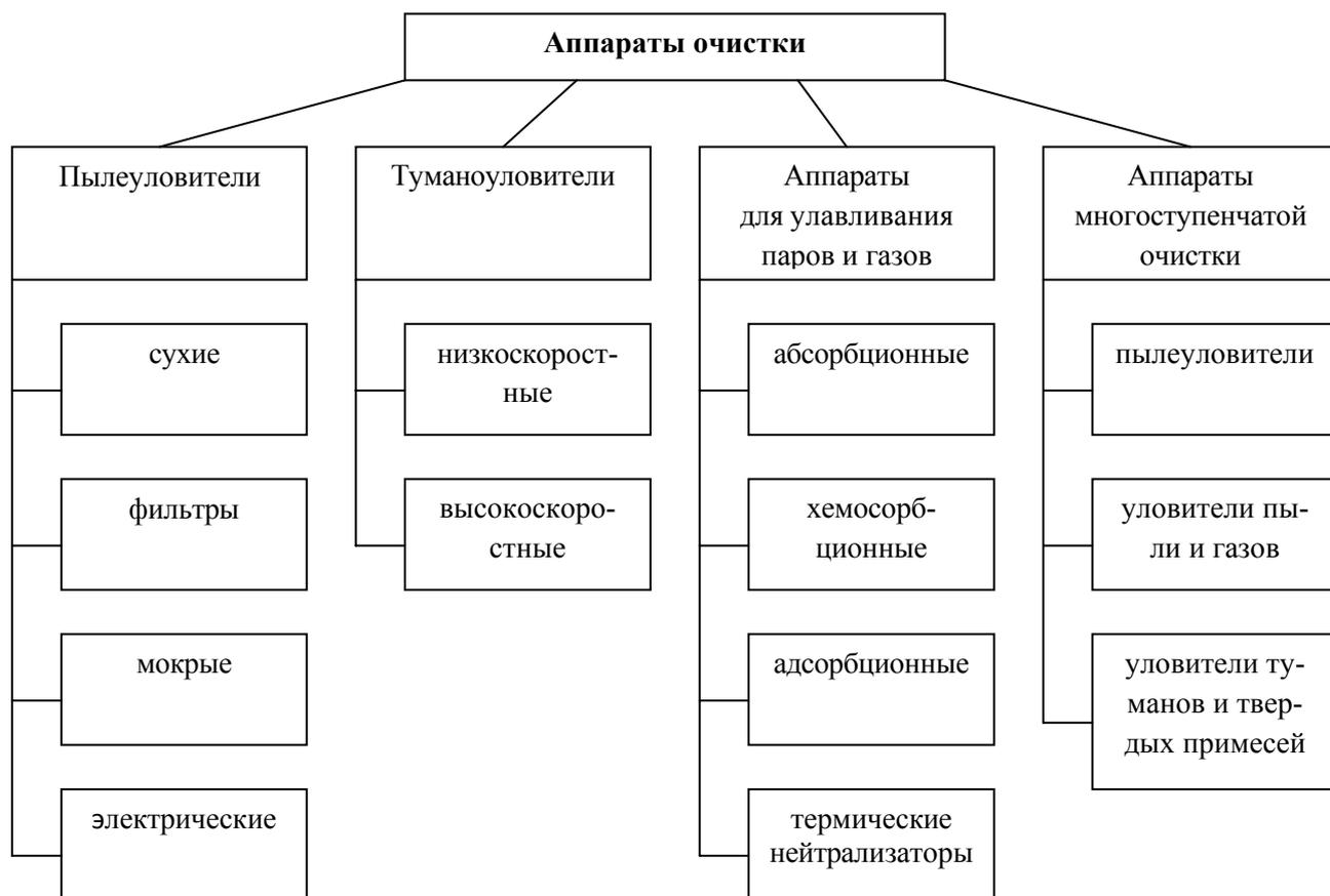
Рис. 1. Классификация аппаратов очистки вентиляционных технологических газовых выбросов
