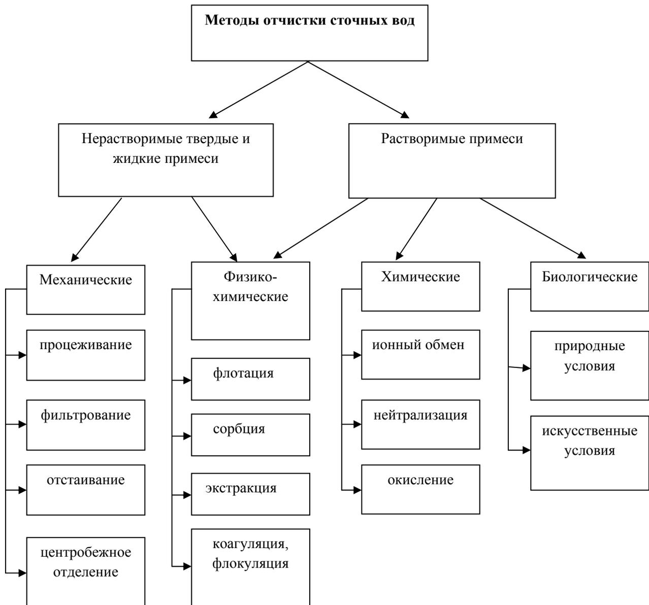
Рис. 8. Методы очистки сточных вод
