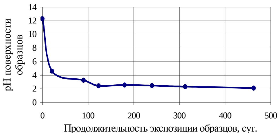
Рис. 2.6 - Влияние продолжительности экспозиции на pH поверхности бетона
