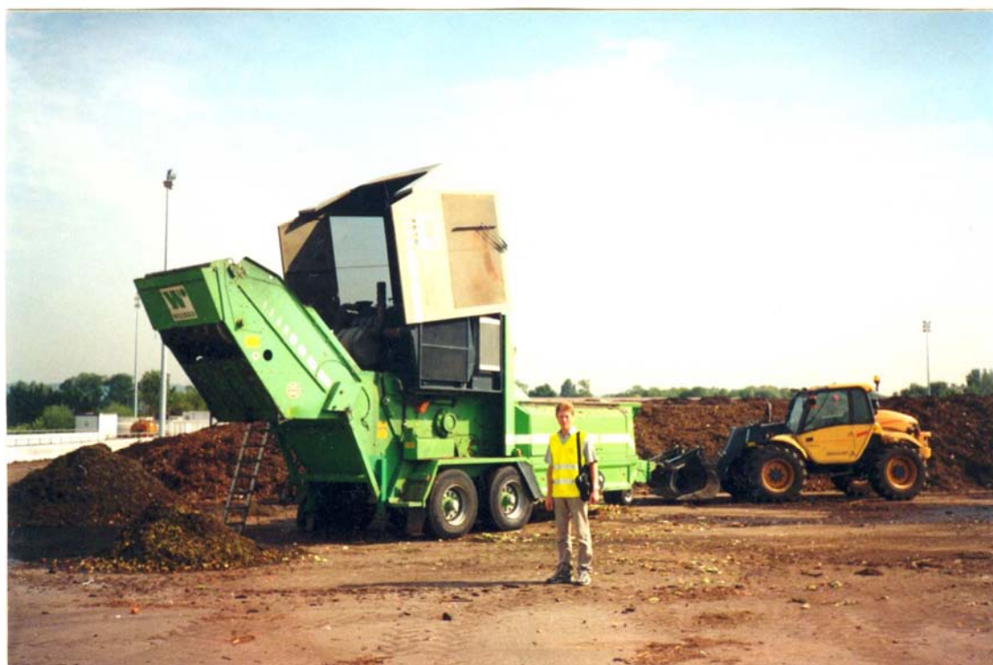
Рис. 1.18 – Установка обработки компоста на станции компостирования садово-парковых отходов в г. Лионе (Франция). Осуществляет операции просеивания компоста и извлечения из него крупных фракций и посторонних предметов
