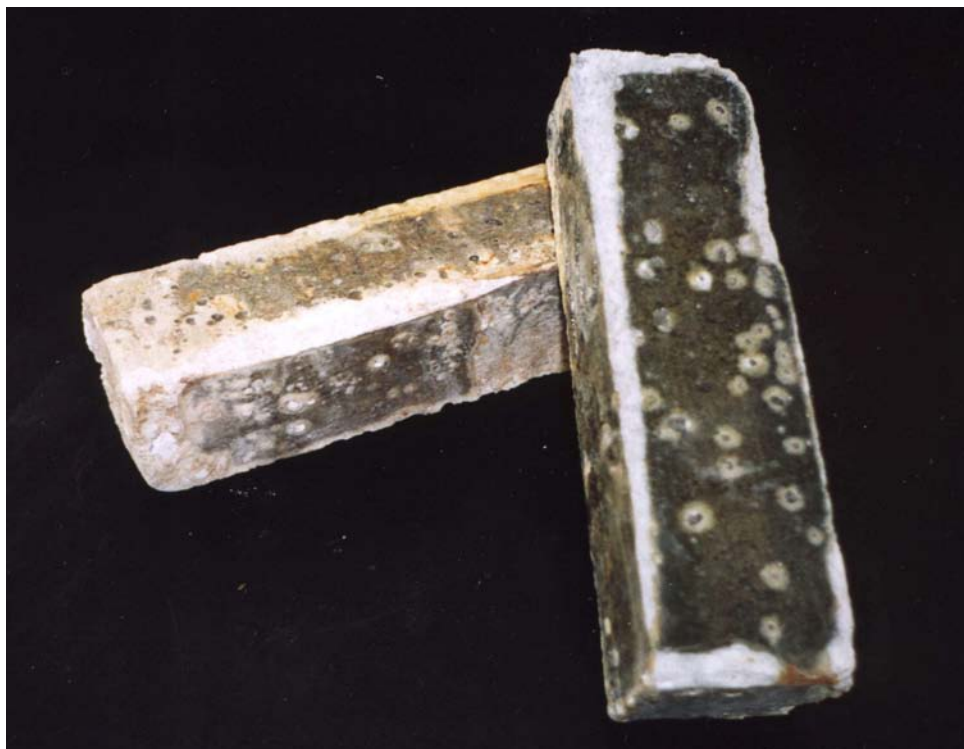
Рис. 2.4 — Образцы бетона, покрытые эпоксидной композицией (СНиП 11-28-73), после 115 дней экспозиции на своде коллектора (слева – покрытие без биоцида, справа – с биоцидом)
