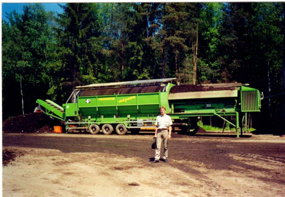
Рис. 1.17 – Установка обработки компоста на станции компостирования садово-парковых отходов в г. Нюрнберге (ФРГ). Осуществляет операции просеивания компоста и извлечения из него крупных фракций и посторонних предметов
