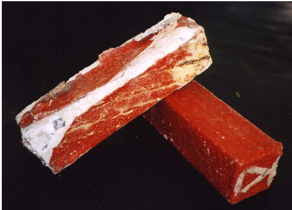
Рис. 2.4 — Образцы бетона, покрытые эпоксидной композицией (СНиП 11-28-73), после 115 дней экспозиции на своде коллектора (слева – покрытие без биоцида, справа – с биоцидом)
