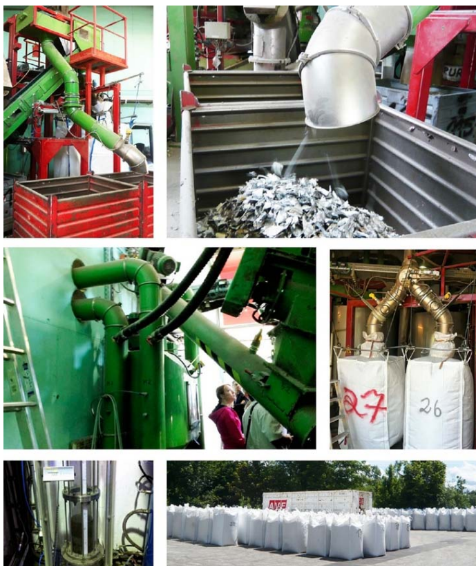
Рис. 3.26. Процесс измельчения корпуса холодильника
