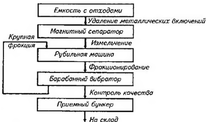
Рис. 4.2. Технологическая схема производства щепы
