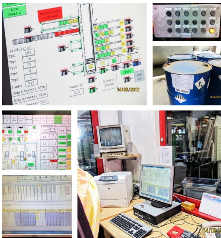
Рис. 3.27. Компьютеризированная система контроля процесса утилизации холодильников
