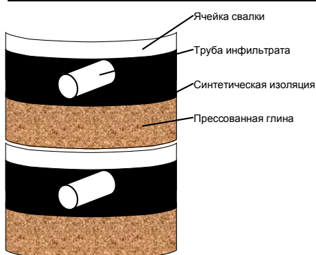
Рис. 7.9. Разные системы изоляции для обеспечения сбора инфильтрата
