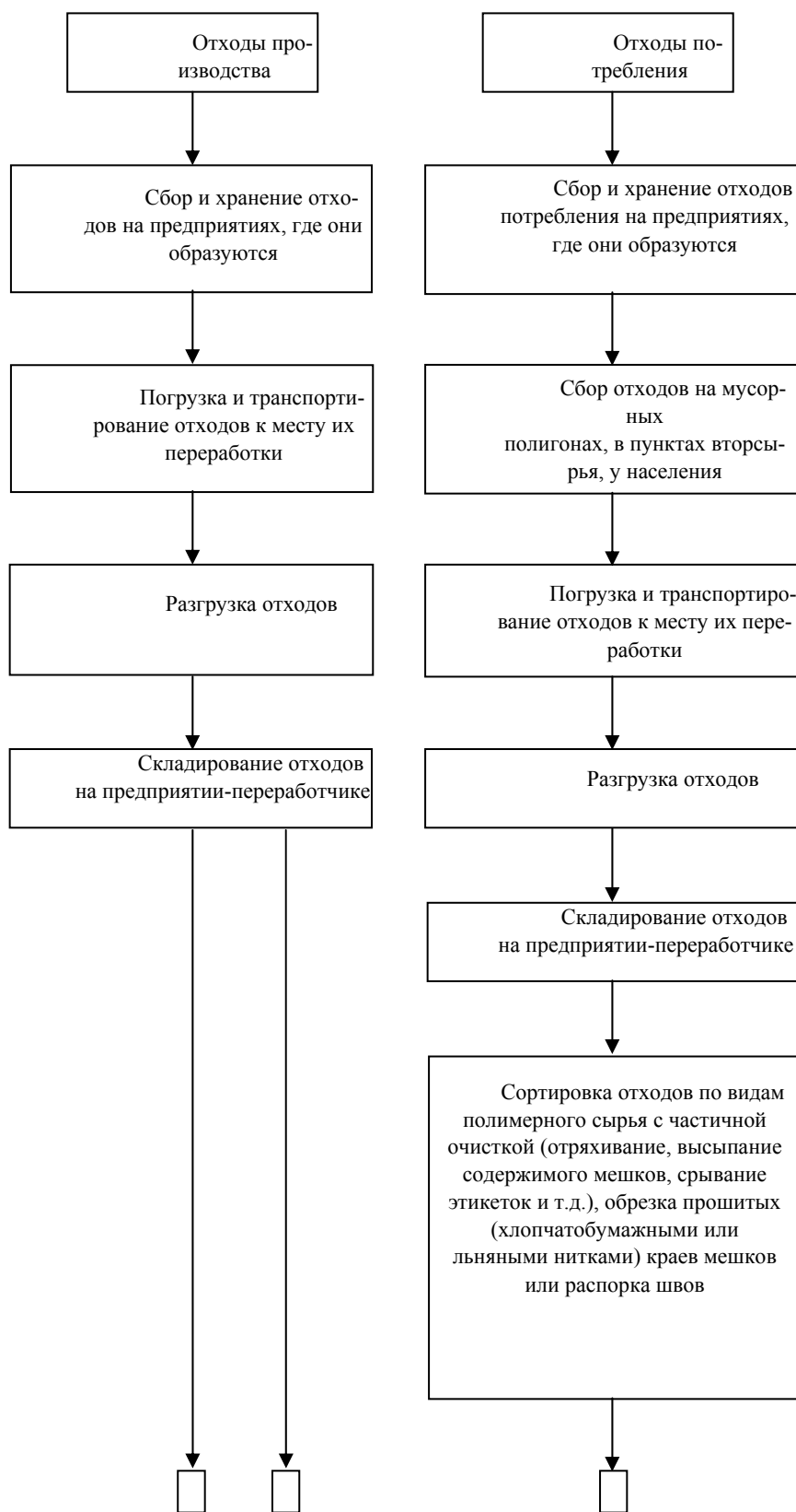
Рис. 2.4. Схема технологического процесса переработки отходов
