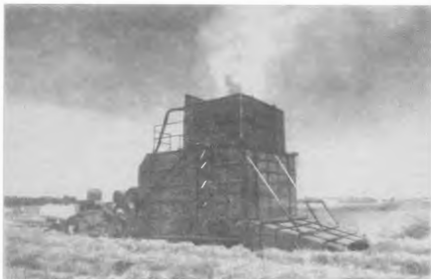
Рис. 11.4. Экспериментальная передвижная полевая печь для сжигания соломы с минимальным загрязнением воздуха
