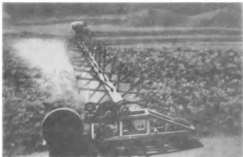
Рис. 11.3. Вращающийся разрыхлитель для аэрации и сушки птичьего помета
