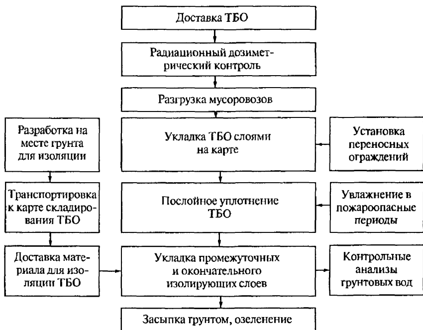
Рис. 7.1. Структурная схема основных операций, выполняемых при эксплуатации полигонов ТБО
